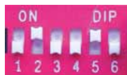
Bloc comprenant les 6 commutateurs DIP
