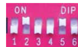
Bloque con 6 conmutadores DIP
